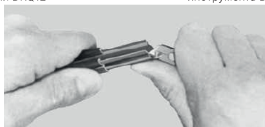
Рис. 10: удаление внутренних заусенцев скользящей линии инструментом
