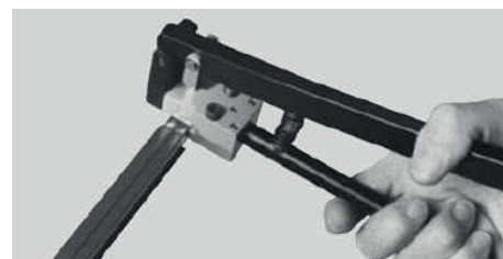
Рис. 8: схема работы пробивного инструмента DKQ12
